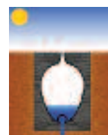
Konec srážek, regulovaný odtok pokračuje, hladina vody v žlabovém systému klesá.
