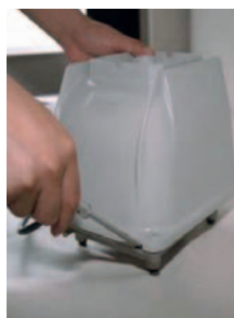
3. Pokud nejde hlavní kryt odejmout, vsuňte mezi hlavní kryt (3) a základovou desku (18) šroubovák.
