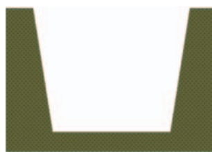
1. vyhloubení stavební jámy
