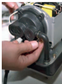
9. Sejměte spojovací hadici (13) a těleso ventilu (12), stáhněte hadicovou svorku (14).
