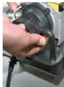
9. Sejměte spojovací hadici (13) a těleso ventilu (12), stáhněte hadicovou svorku (14).
