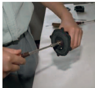
3. Uvolněte šroub (EL-120: (29), EL-200 a EL-250: (30)). Nahradte magnet (9) novým.
