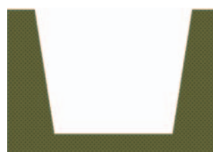
1. vyhloubení stavební jámy
