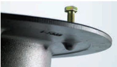
Šroub v přírubě ve slepé díře se dnem, v přírubě není průchozí závitový otvor, tím je utěsnění bezpečné a trvalé
