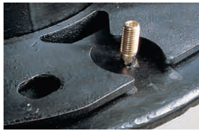
Detail mostního odtoku Multitop HSD-2: límeček talíře a přitlačný kroužek se vsakovacími otvory pro napnutí těsnícího pásu
